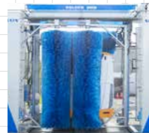
左右サイドブラシが中央に来た時点で逆回転し、洗浄力を高めます
