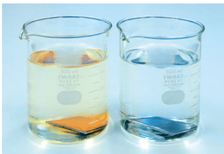
水道水 (12時間で発錆 3日間放置)
